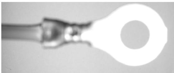
図:圧着完了 圧着の跡が付いている
