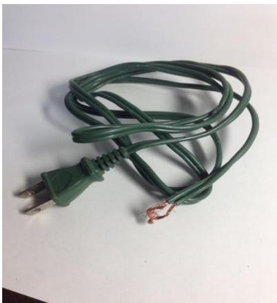
コンセントを接続するためのプラグの一種。一括購入で0.75mm(許容電流7A)平行コード付きプラグが購入できる。ただし、7A以上の電流を流す場合はコードなしのプラグを購入して、自分でコード作ることもできる。1年生の場合、このコードを6つくらい買っておけば十分だろう。(ただし、もちろん、すべての回路に流れる電流が7A以下と仮定する。)
