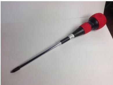
ソケットに銅線を接続するとき、ソケットを支柱に固定するときを使う。ただすべての作業をこういった普通のドライバーで行うと時間がかかるため、後述する**電動ドライバー**、または**ラチェットドライバー**と一緒に使うのがよいだろう。刃先は+2というものを使おう。なお使用するドライバーはできるだけ図のように持ち手から先端まで長めのものにしておこう。
