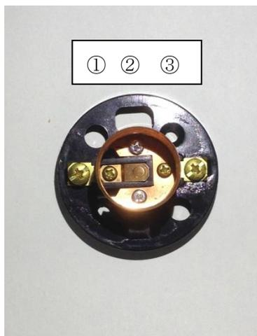
左図の左の穴から順に穴が3種類ある。①の穴は「飛ばし」(木材がない所に針金でレセップを針金に固定する方法)を作るときに針金を通す穴。ただしレセップはプラスチック製なのであまり力強くやりすぎると割れてしまう。②の長方形上の穴は、コードをここから通し横の穴から出すことでコードを挟まずにキャップを閉められる。要はコードを通す穴。③は①よりも小さな穴でここにねじを入れてねじ止めを行う。
