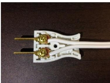
プラグを作る場合は、プラグのカバーを外すとレセップのときのようにコードを巻きつけるためのねじが二つ見つかるので、レセップユニット作成時と同じように、コードを適当な長さに切り、先端のコードの被膜を剥いてねじで固定する。プラグ付近のコードにビニルテープを貼り、マジックペンでど
